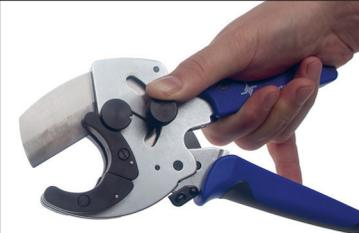
1. Spannen Sie das Messer am Knauf mit dem Daumen auf und legen Sie das Schneidwerkzeug an der Schneidestelle an das Kabel. Nehmen Sie den Daumen vom Knauf. Die Auflagebacken sorgen für eine optimale rechtwinklige Position des Kabels in Schneidwerkzeug.
