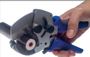
2. Rotieren Sie das Werkzeug mehrfach um das Kabel, ohne hohen Druck zu verursachen, um insbesondere den Außenleiter vorsichtig zu schneiden statt zu quetschen. Geben Sie nach und nach behutsam mehr Druck auf die Griffe, während Sie weiter rotieren, um das Kabel vollständig und sauber zu durchtrennen.
